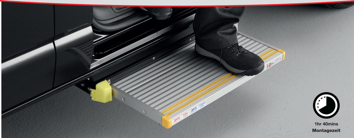
**Die SLE-Reihe** – Eine Kassettenstufe mit unglaublich schlankem Profil für verschiedene Fahrzeugtypen.
